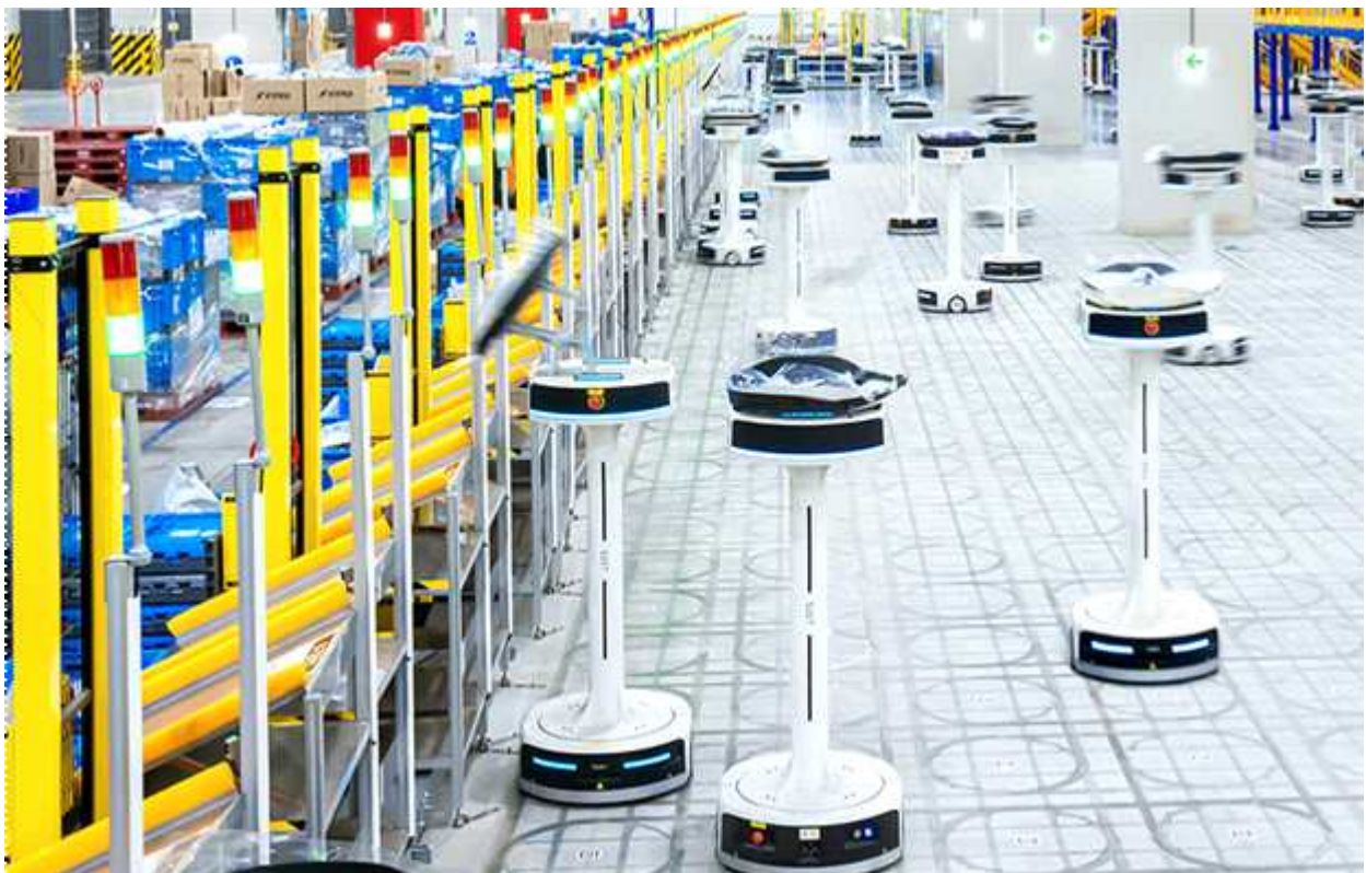
[그림] 쿠팡 대구 풀필먼트센터의AGV·소팅봇 운영
