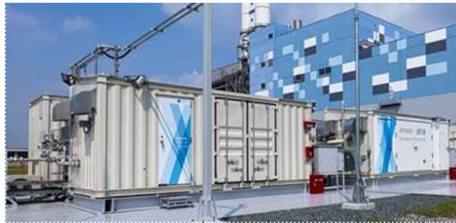
[그림] Denso사의 200 kW급 SOEC 시스템. 수증기 재순환 이젝터 사용이 특징
