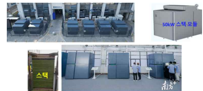
[그림] CCTC 사의 셀, 스택, 300kW SOFC 시스템 (50kW/스택모듈)
