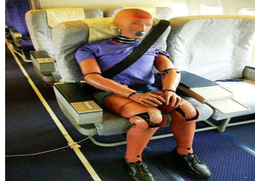
[그림] 국외 EMAS 탑승객 안전 실험 (좌:미국, 우: 중국)
