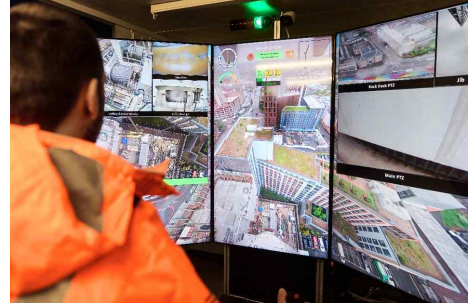
그림 35. Skyline Cockpit 원격조종 타워크레인 (출처: Radius Group, Vertikal)
