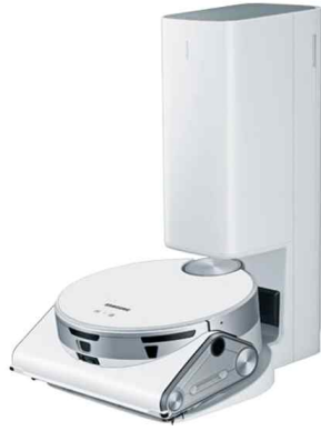
그림 25. 청소 로봇 도킹 스테이션 예시(좌) 및 로봇 무선 충전 시스템 예시(우)
