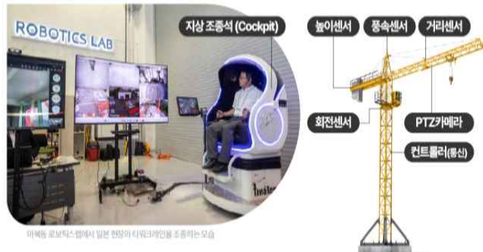
그림 32. 원격 타워크레인 타와레모(TawaRemo) (출처: 현대건설)
