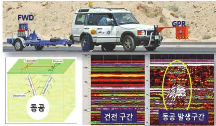
[그림] 도로함몰 위험도 탐지시스템 개념
