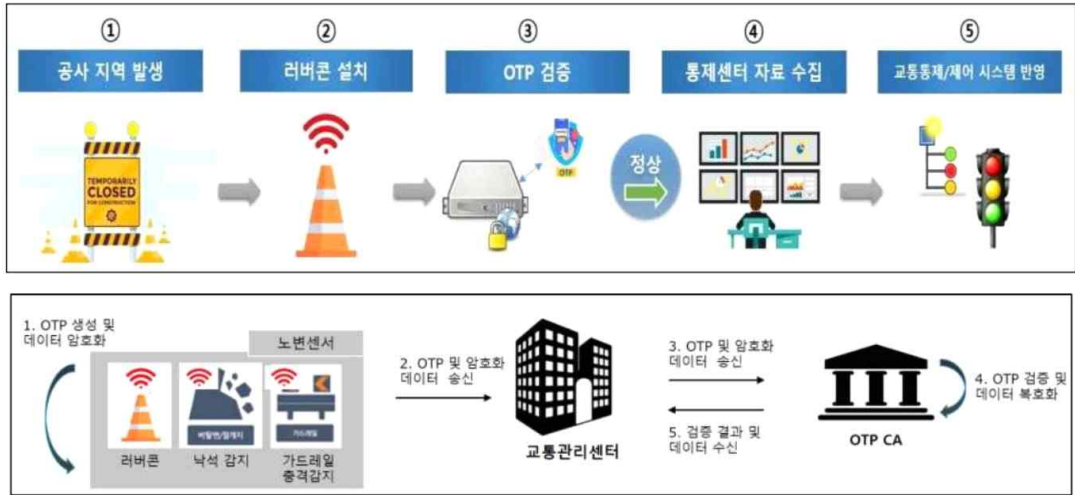
[그림 143] 도로교통 통합보안 인증시스템 운영 시나리오 및 흐름도
