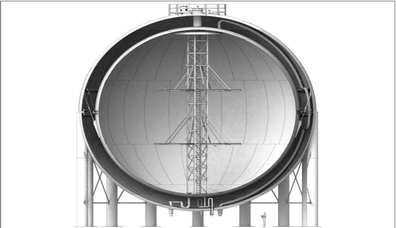
〈그림 5-12〉 (세부 1-3) 내부 Vertical 재액화 열교환기가 적용된 구형 탱크(NASA)
