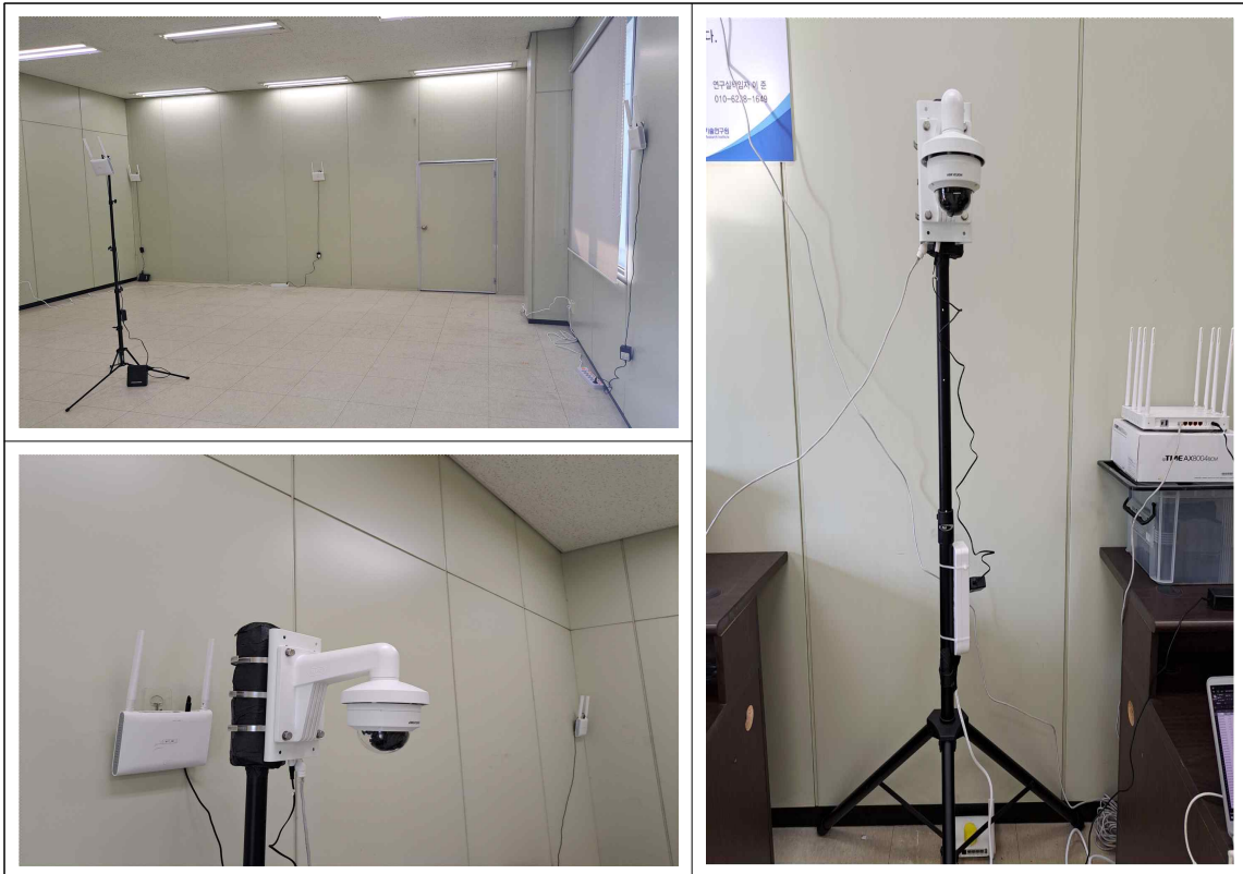
그림 2-4-18 센서(영상 및 무선신호) 융합 기반 부정 승차 감지 기술 테스트베드 구축
