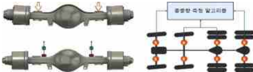
<그림 112> 미소 변형량 측정용 로드센서 설치 예시(좌), 총중량 측정 예시(우)
