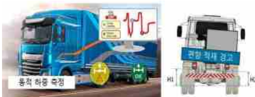
<그림 114> 동적하중 측정 알고리즘 개발 및 편향 적재 경고 예시
