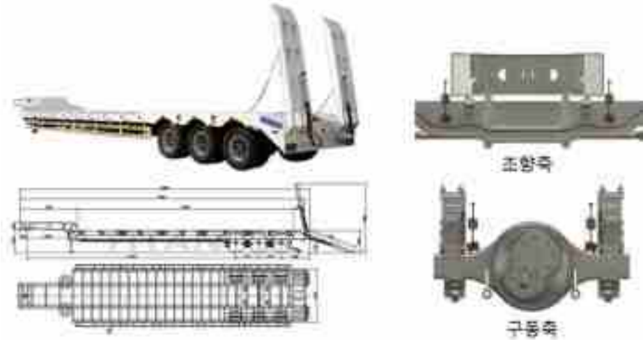
<그림 115> 로베드 트레일러 구조 및 축별 자중계 장착 예시
