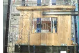
개구부가 있는 CLT 횡하중 파괴모드 (출처: Isoda et al. 2023)
