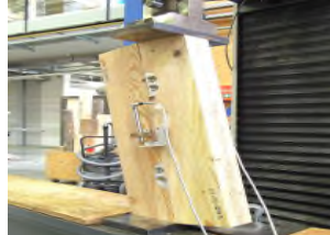
패널-패널 결합의 접합부 전단시험 (출처: 우디즘목재이용연구소)
