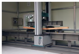
30톤 UTM 휨강도 시험 (출처: 우디즘목재이용연구소)
