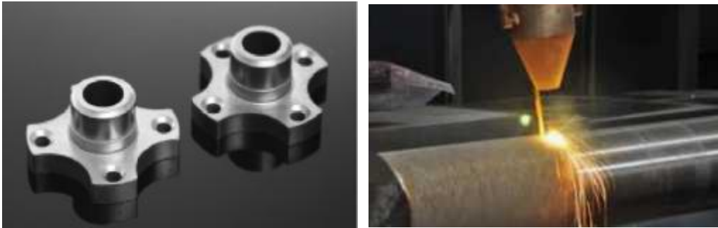
[그림 23] 하드페이싱 및 레이저클래딩을 이용한 마모면 복원 기술(예)
