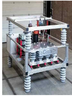
24kV DCCB (SciBreak)
