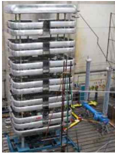
350kV DCCB (ABB)
