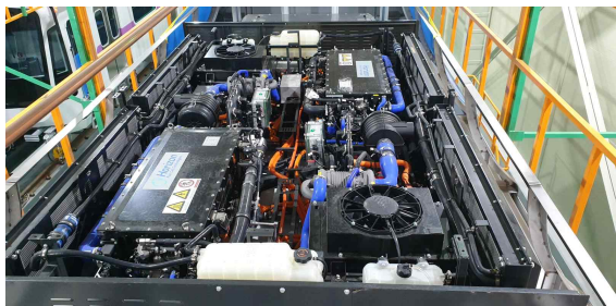
[그림 27] 수소연료전지 하이브리드 추진시스템을 장착한 수소전기동차
