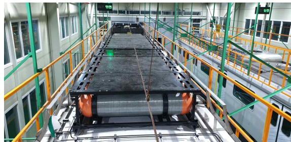
[그림 27] 수소연료전지 하이브리드 추진시스템을 장착한 수소전기동차
