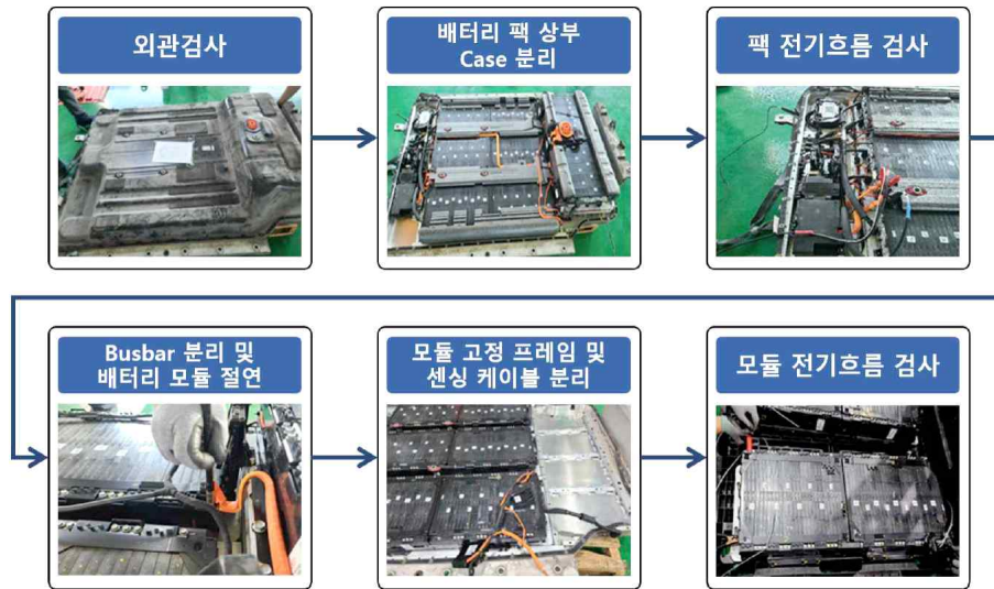
[그림 4] 전기차 배터리 해체 및 검사 도식도
