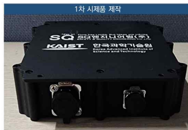
그림. 스마트변위센서의 IP66에 적합하도록 방수 방진 케이스를 설계해 1차 시제품을 제작함.
