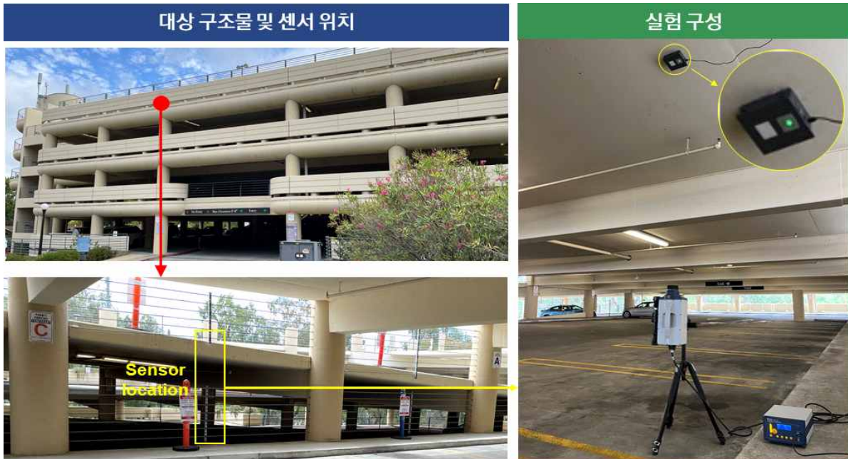
그림. 스탠포드대 Via Ortega 주차빌딩 변위계측 현장적용 실험을 통해 1mm 이내의 중소형구조물 변위계측 성능을 입증함.
