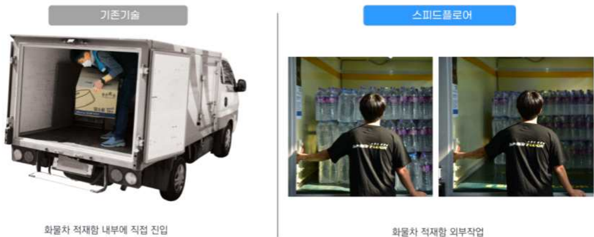
그림 35 일반 내장탑차(저상형)와 신청 기술을 적용한 차량의 상하차 작업 차이
