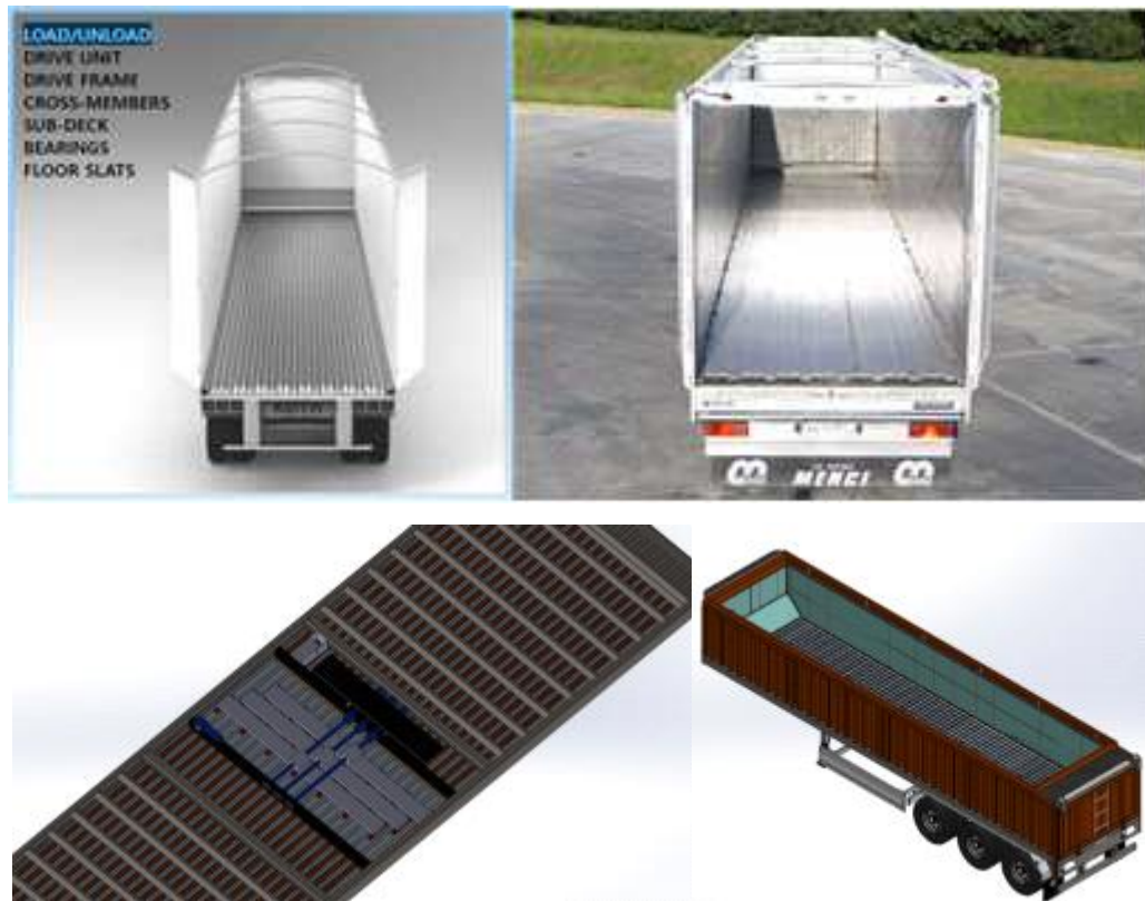
그림 31 WALKING FLOOR 시스템 적용 트레일러
