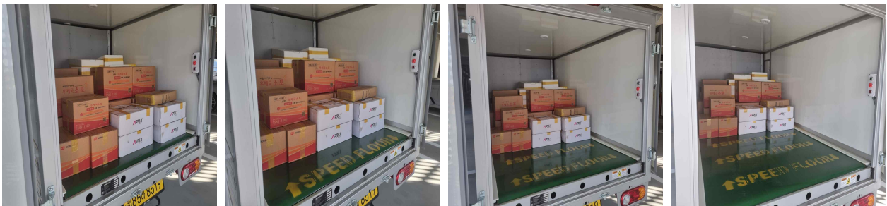
<버튼 조작을 통해 화물이 좌측부터 들어가거나 우측부터 나오는 모습>
