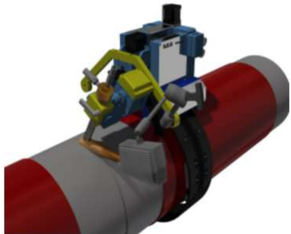
〈그림 52〉 배관자동정렬 및 관자동용접 장치
