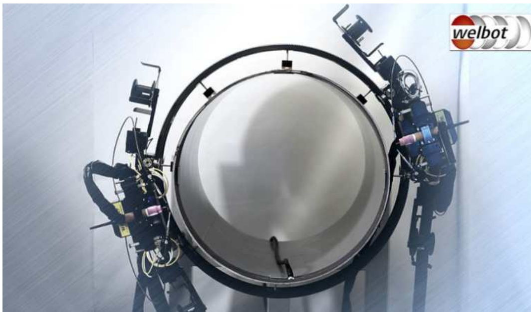
〈그림 54〉 다관절 로봇용 자동 티그(TIG) 용접로봇(WELBOT)
