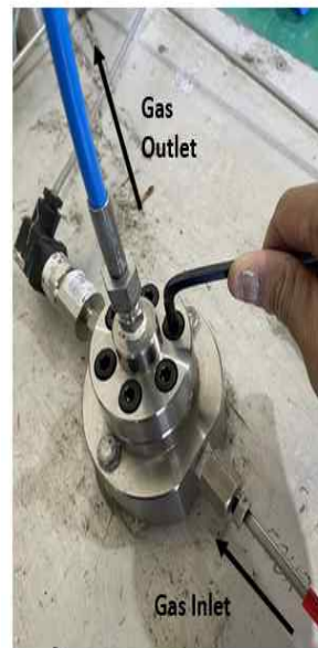
〈그림 193〉 수소취성평가 장비 구조 및 대체시험방법의 디스크파열시험 장비
