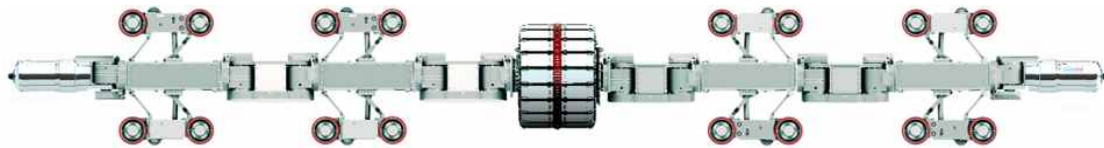
〈그림 210〉 Pipetel Technologies의 자가추진 배관검사 로봇
