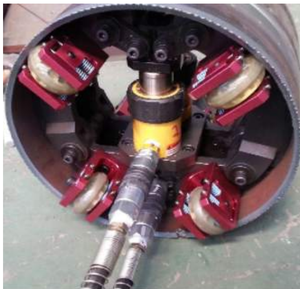
〈그림 52〉 배관자동정렬 및 관자동용접 장치
