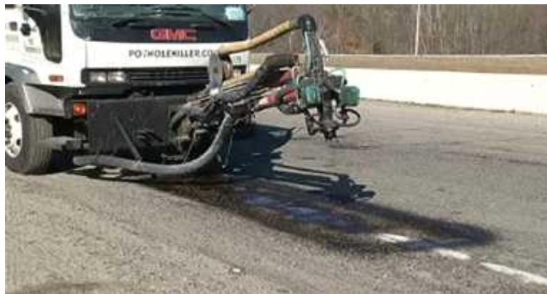
[그림 50] 미국 로드아일랜드의 포트홀킬러 (pothole killer)
