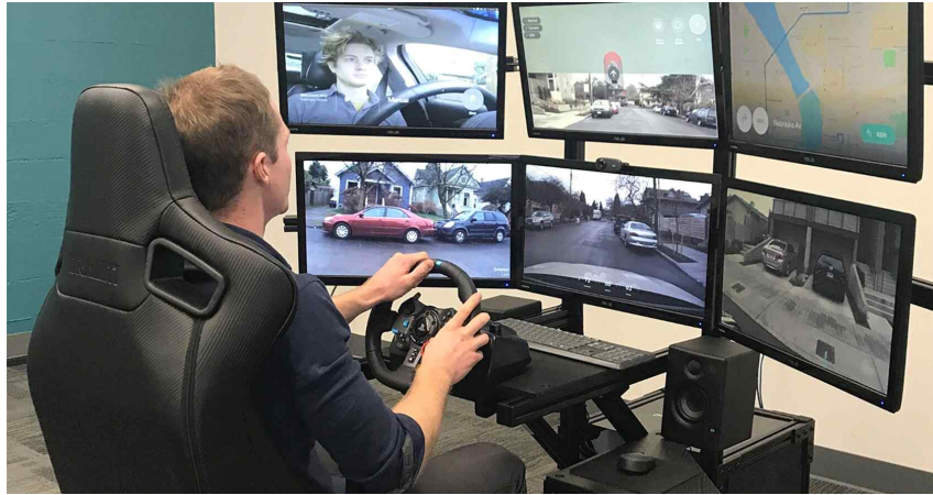
〈그림〉 미국 Designated Driver와 Autonomoustuff의 자율차 원격조정 툴킷 (자료: https://autonomoustuff.com/kits/designated-driver-teleoperations-kit )
