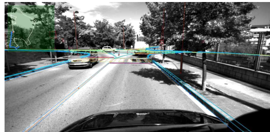
〈그림〉 HD맵 구축 도로(좌), OpenDrive HD맵을 자율차 영상에 투영한 이미지(우)
