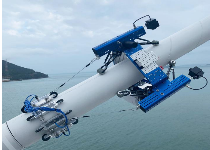
[그림] 케이블 교량 안전 점검 및 유지관리를 위한 전자기센서와 견인로봇
