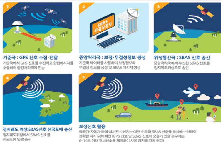
[그림] 한국형 항공위성서비스(KASS) 동작 원리
