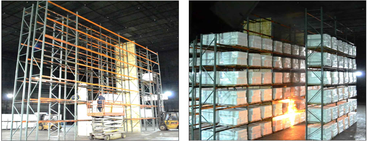
<그림 2-41> 랙크 내부 수직 차단막의 화재대응 성능평가 실험
