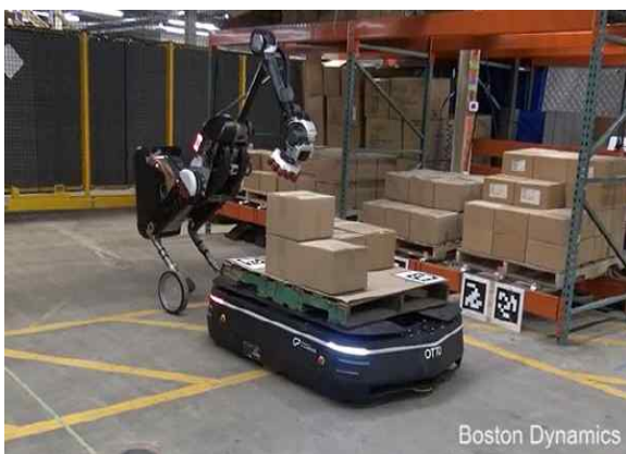
<그림 2-47> 하역 로봇과 이송 로봇을 이용한 물류창고 자동화
