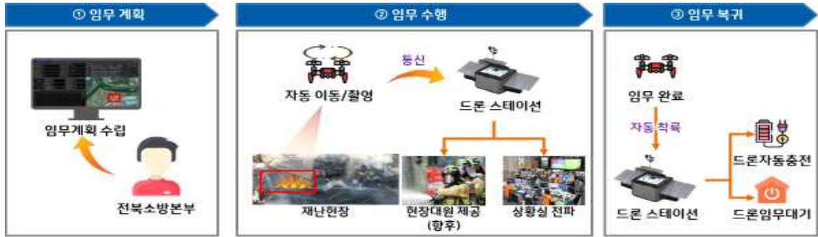
<그림 2-24> 드론 활용 화재감시 시스템 개요
