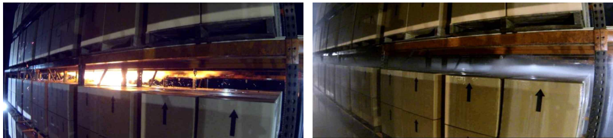
<그림 2-42> 랙크 내부 수평 차단막의 화재대응 성능평가 실험
