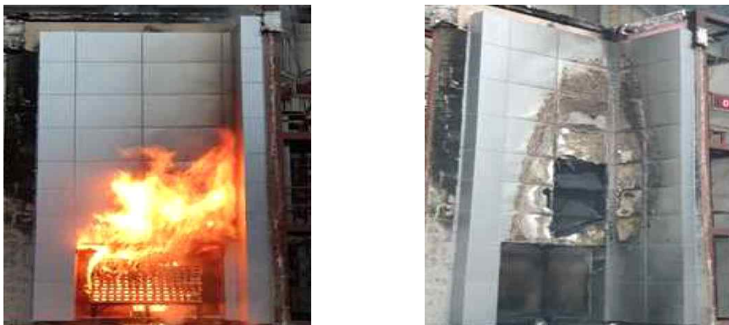
<그림 2-57> 화재안전과 단열성능의 확보가 가능한 외벽시스템에 대한 성능실험
