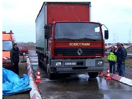
[그림 4] 프랑스의 LS-WIM 현장시험
