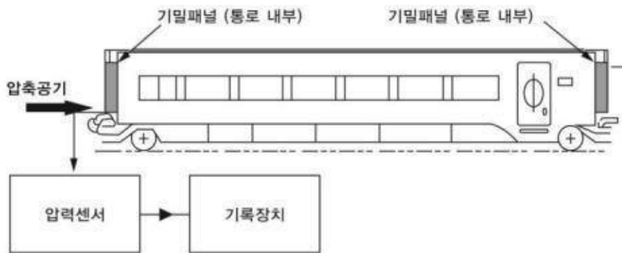
그림 5-8. 완성차시험 예 : 기밀시험 측정장치 설치
