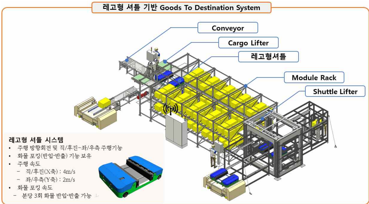
[그림 2] 레고형 셔틀 시스템 기반 Goods To Destination System
