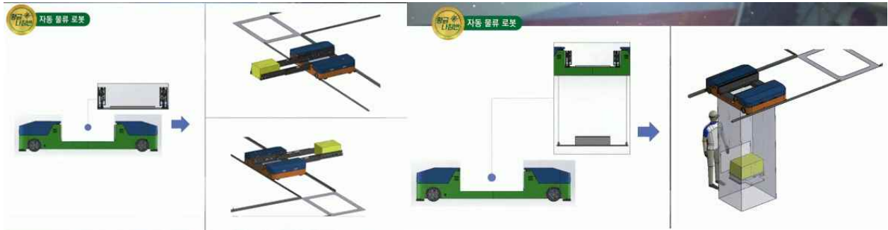
[그림 8] 고객 수요에 따라 기능모듈 교체가 가능한 시스템
