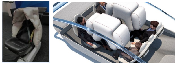
〈그림〉 자율주행차 내 신개념 충돌안전장치열 방식의 예
