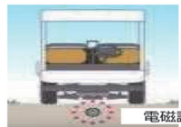
▲電磁誘導線による自車位置特定による運行の補助
