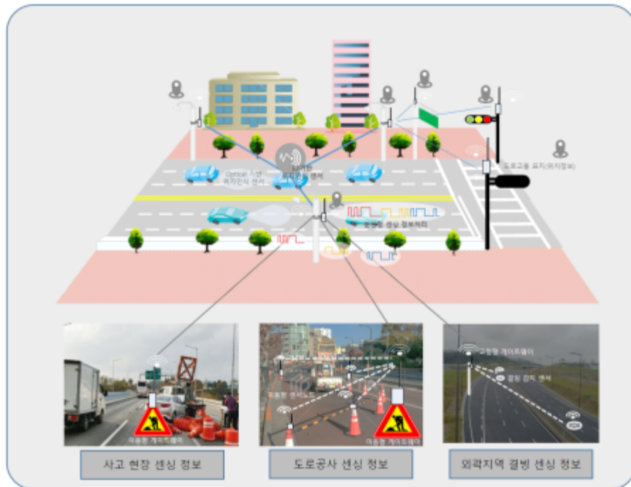
〈그림〉 초 저전력 무선 센서 네트워크 기반 도로상황 데이터 수집 개념도
