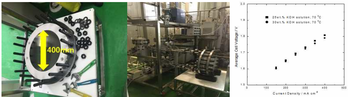
그림 25. 국내에서 개발중인 AE 시스템 전극 효율 및 스택 사진
