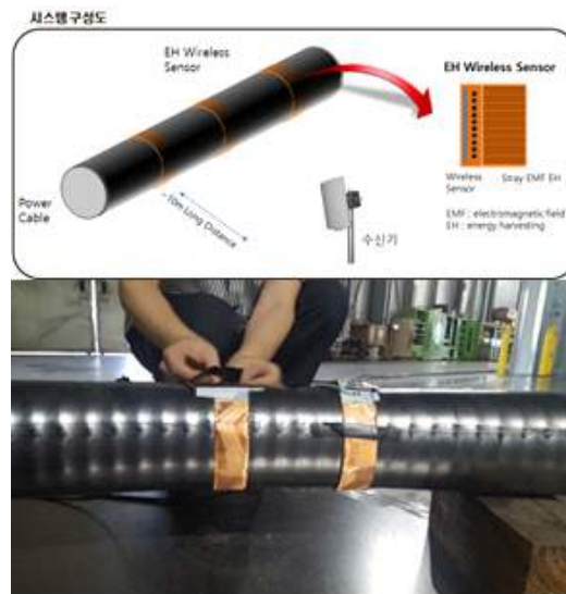
그림 2-3-30 송전케이블 부착형 에너지하베스터
