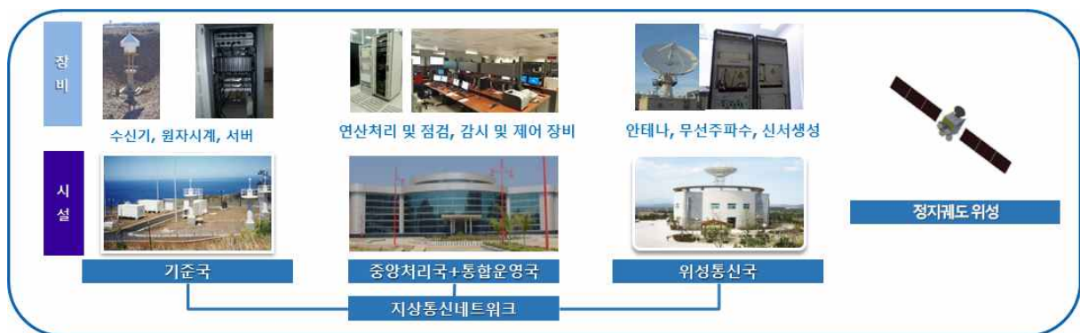
[ 그림 1-1 ] 한국형SBAS 시스템인 KASS의 구성요소
