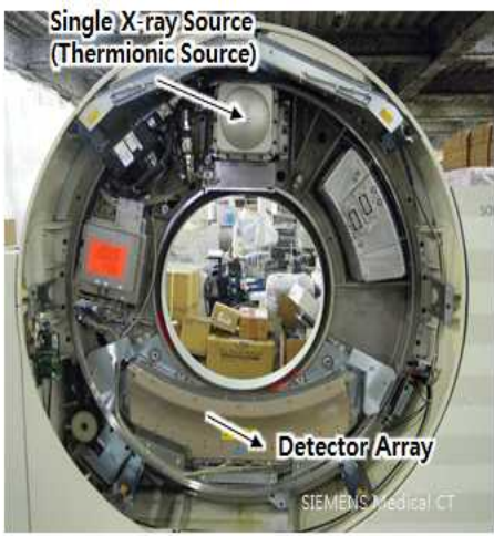
[그림 4-7] 휴대수하물 검색을 위한 3차원 디지털 엑스선 시스템 기술(As-is)
