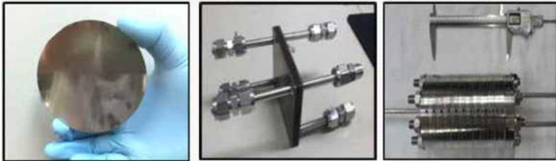
[그림 2-2-11] 국내 개발 중인 평판형 수소 분리막 및 모듈 (출처: Energy Innovator, 고성능 수소분리막 및 이의 모듈화 기술, 한국에너지기술연구원)
