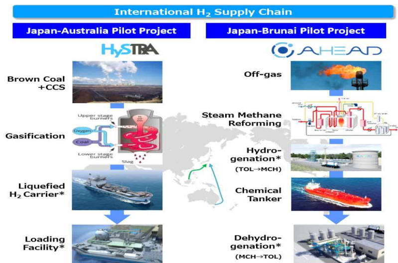
[그림 8-1-1] 일본 정부의 호주/브루나이 정부와 석탄가스화, 천연가스 개발을 통한 해외수소 생산 협업사례 (출처: Challenges for Japan's Energy Transition-Basic Hydrogen Strategy, 일본 통산성, 2018/10)
