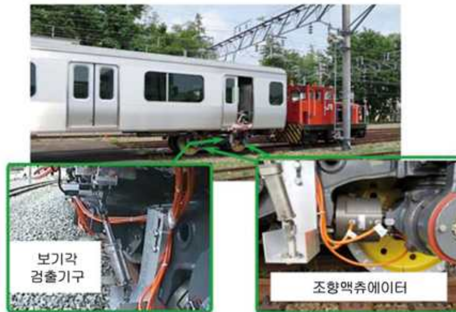
그림 2-3-11 어시스트 조향시스템 적용 시험차
