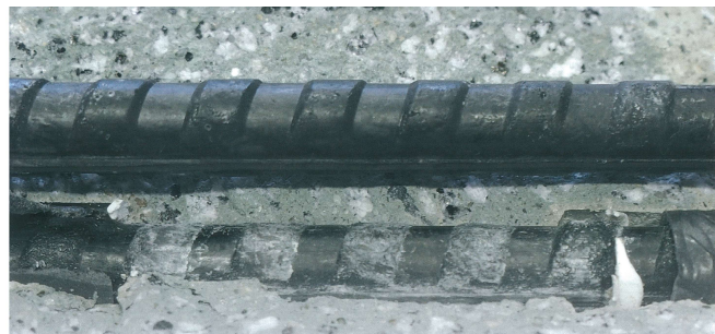
[그림 81] 탄소보강근-콘크리트 상호 작용
