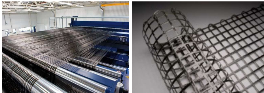
[그림 94] 탄소그리드 생산 및 제품 예시
