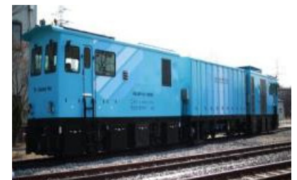
<지하철 객실 내 공기정화장치(上), 터널 내 미세먼지 집진 차량(下)>
