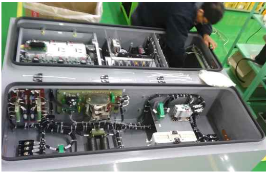
<부품 조립 및 배선>
