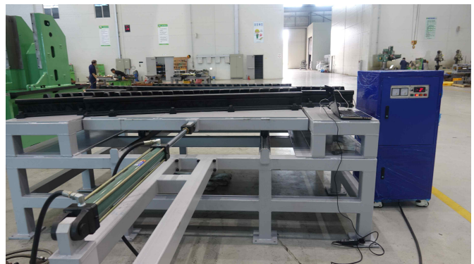
<제작된 테스트용 분기기 및 선로전환기>
