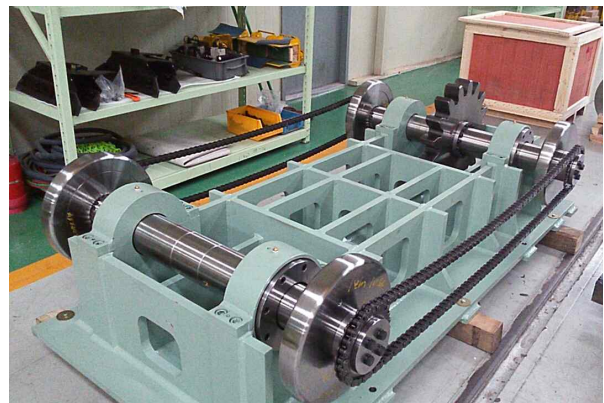
<대차 동특성 시험장치 Roller Rig 제작>
