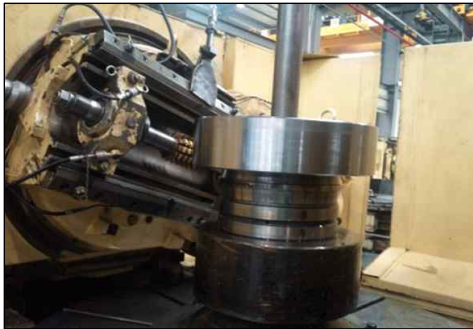
<탄성 Pinion Part - Gear 제작>
