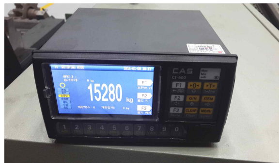
<탄성 Pinion 최대 하중 측정>
