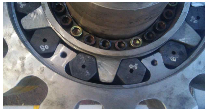
<최대하중 시험 후 탄성체 확인>
