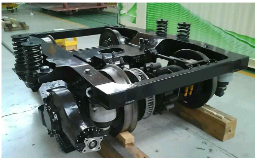
<조립 중인 급구배 추진 대차>
