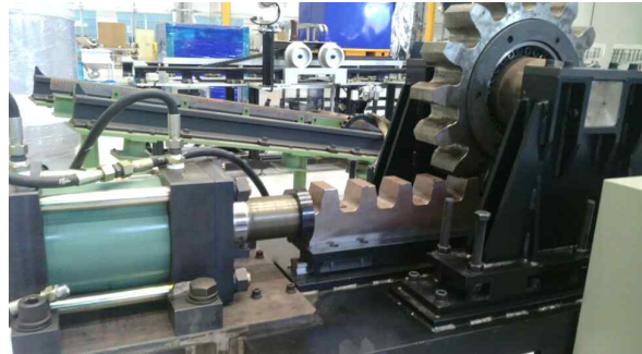
<탄성 Pinion 최대 하중 시험>
