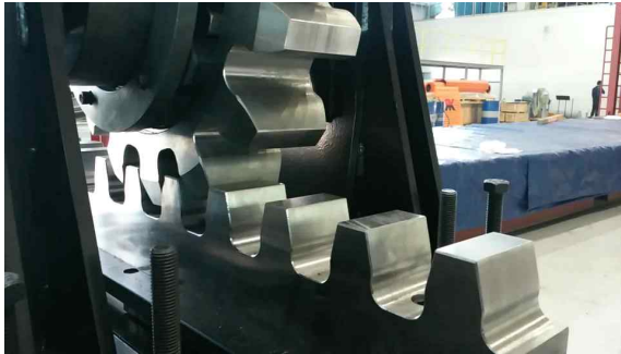
<탄성 Pinion과 Rack 맞물림 상태>
