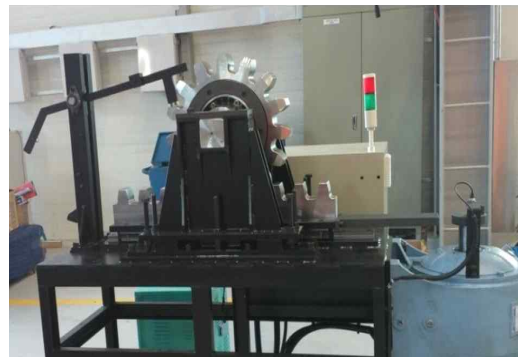
<탄성Pinion 진동 및 내구성 시험장치>
