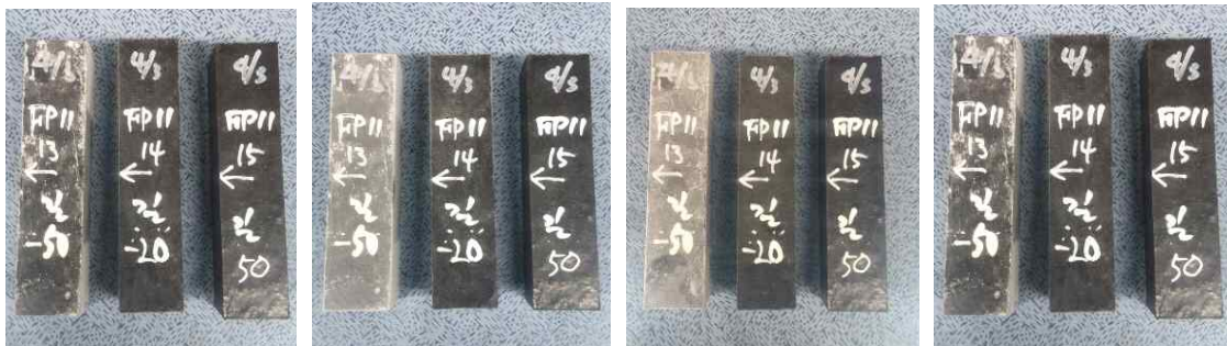
<10사이클 후 외관> <20사이클 후 외관> <30사이클 후 외관> <40사이클 후 외관>
