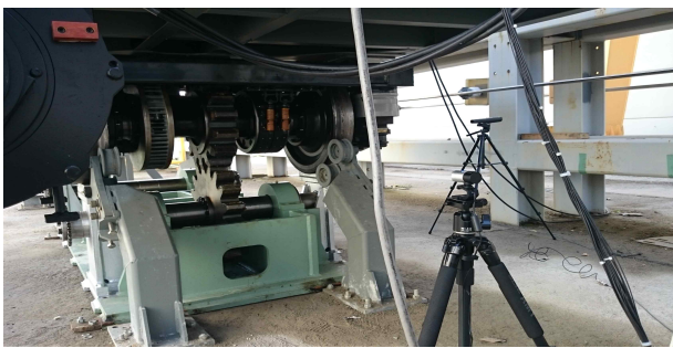
<대차 동특성 시험을 위한 센서 설치>
