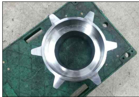
<탄성 Pinion Part - Boss 제작>
