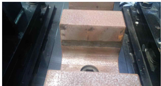
<최대하중 시험 후 Rack 확인>
