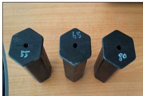
<탄성 Pinion Part - 탄성체 3종 제작>
