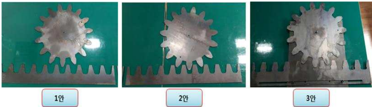
<Rack&pinion 설계 검증을 위한 평면 모형>
