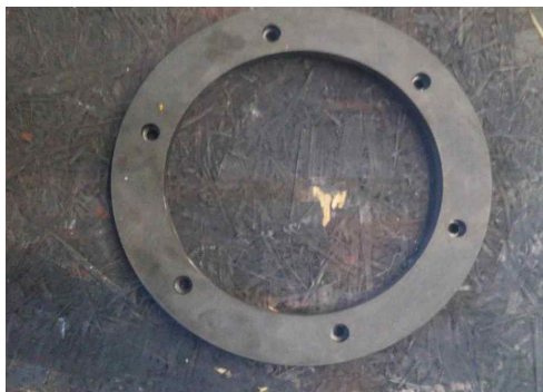
<최대하중 시험 후 Cover 확인>
