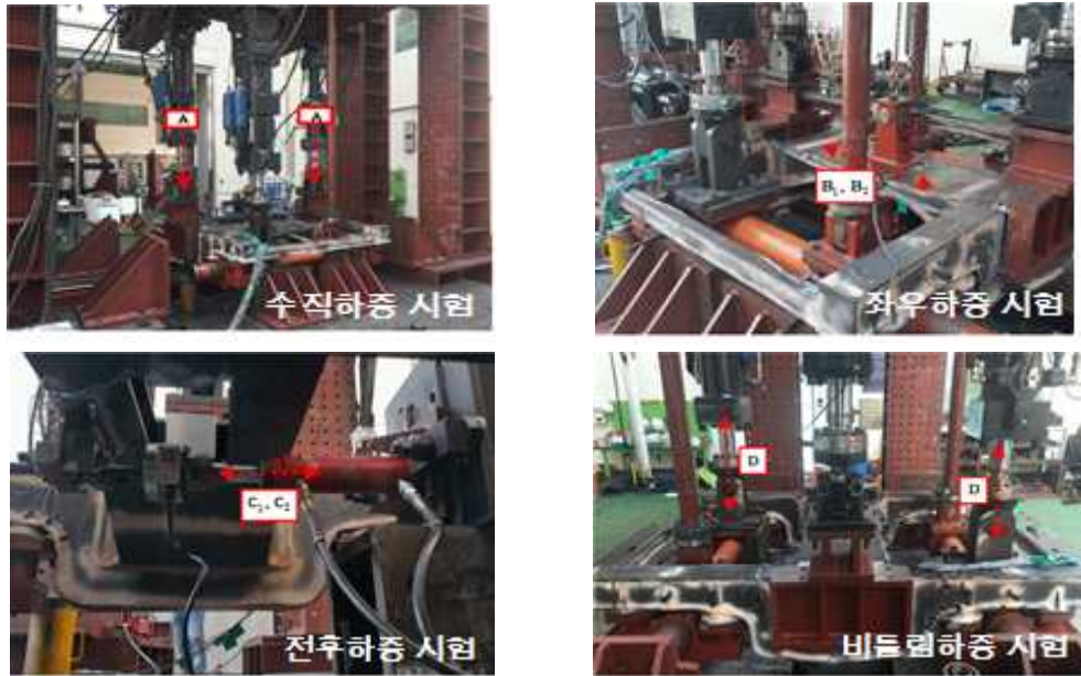
그림 2.28 대차 프레임 하중 시험
