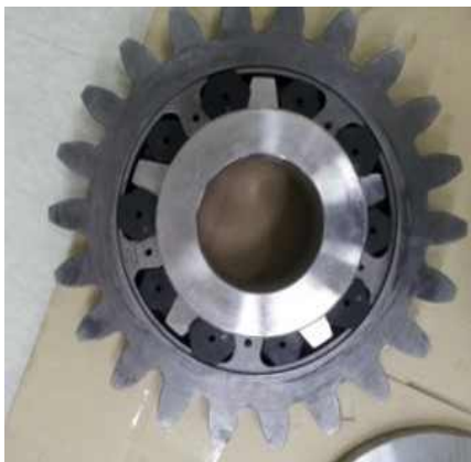
그림 6.11 (좌)탄성 피니언 시제품 (우)탄성 vs. 강체피니언 진동 비교 시험
