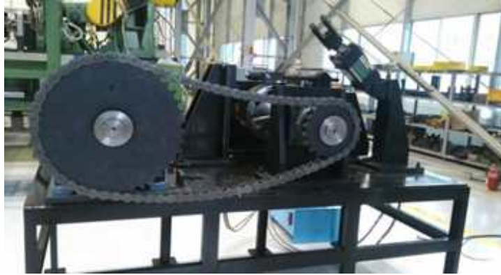
그림 2.55 드럼 제동 장치 성능 시험기
