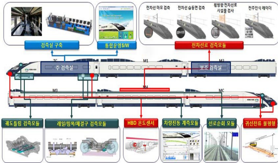
[그림 4.425] 고속 종합검측시스템 개요도
