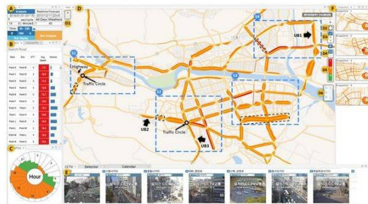
[그림 4.24] 광역시급 도시 전체 도로망의 정체 데이터 분석, 모니터링 및 예측 기술
