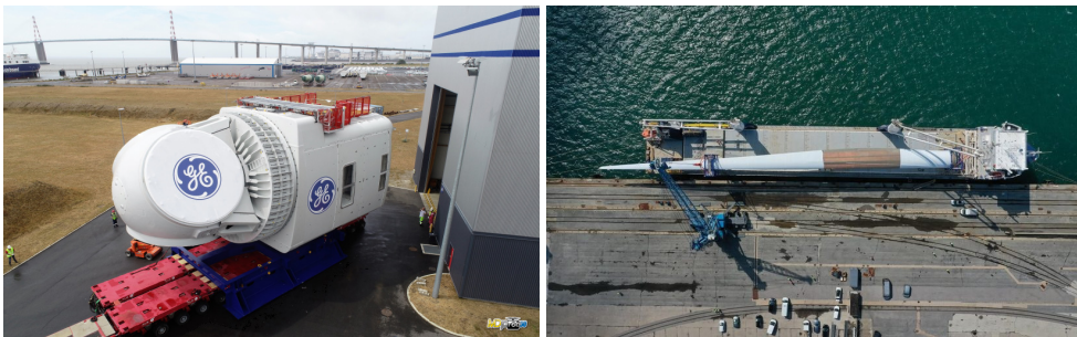
[그림 4.373] GE사가 개발한 Haliade-X 발전기 및 블레이드
