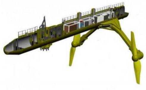
[그림 4.384] STP社가 개발한 부유식 조력발전장치 SR2000
