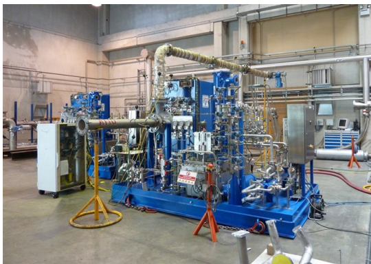
[그림 4.442] 프랑스 Cryostar의 Turbo Expander
