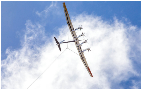
[그림 4.376] Makani사 및 Altaeros사가 개발한 공중 풍력발전장치
