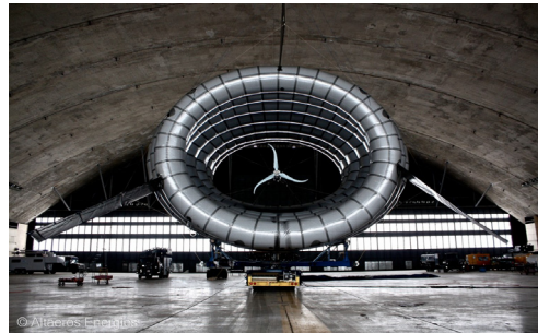
[그림 4.376] Makani사 및 Altaeros사가 개발한 공중 풍력발전장치
