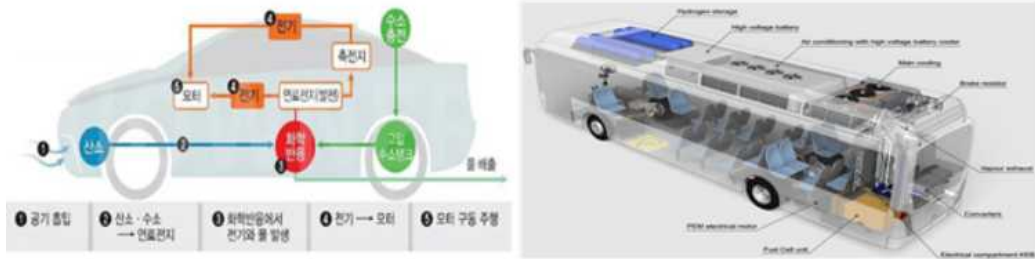
<그림 1-2> 수소전기차 구동시스템 개념도 및 수소버스 구조도
