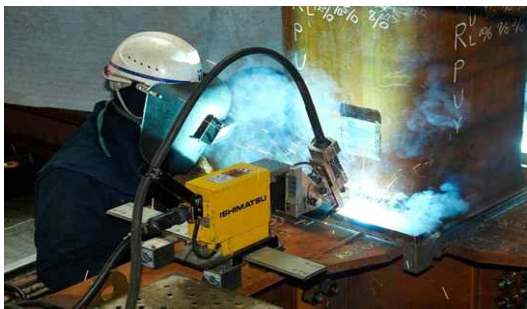
[그림 18] 범용 이동형 용접로봇(출처: 가지마건설)과 T-iROBO Rebar 철근결속로봇(출처: 다이세이건설)
