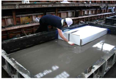
[그림 11] PC에 단열재를 부착하여 공장생산하는 고단열 복합 PC 외벽 시스템과 관련 시물레이션
