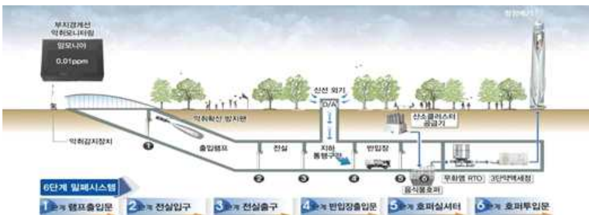
<그림 4-2> 하남유니온파크 6단계 악취 방지 밀폐시스템
