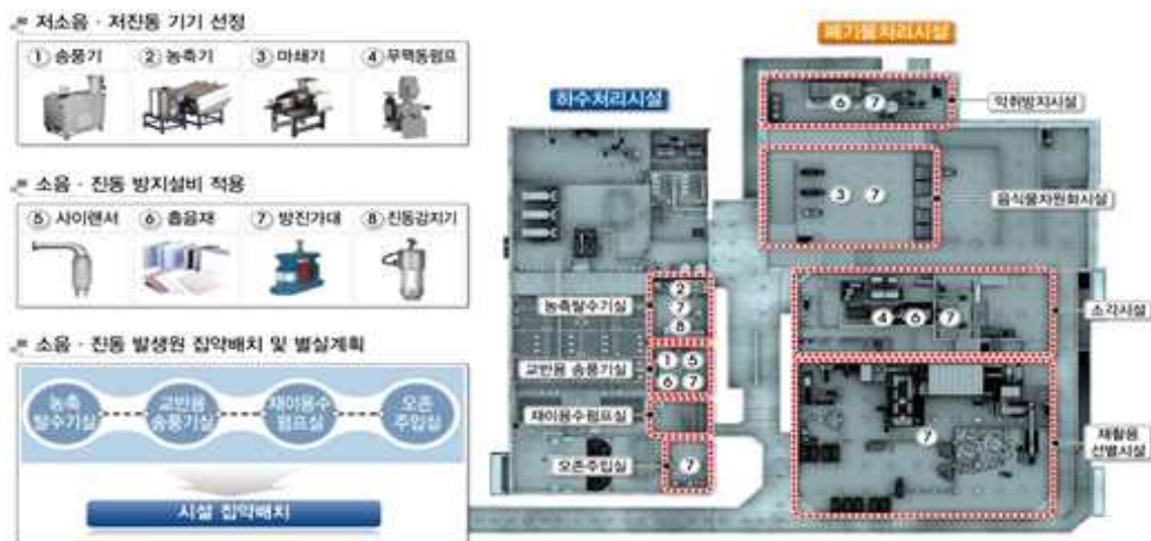
<그림 4-5> 하남유니온파크 저소음·저진동 기기·설비 적용 및 배치
