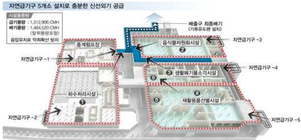
<그림 4-4> 하남유니온파크 자연급기구 환기시스템
