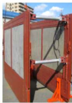
<그림2-49> 매설물 공사를 위한 간이형 수직굴착 흙막이 사례 (영국, 일본)
