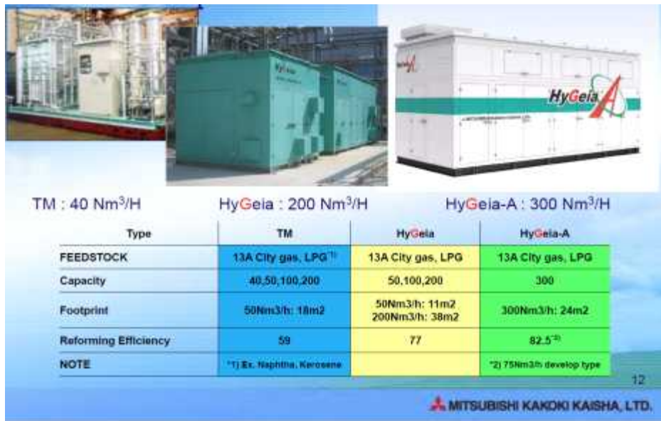
그림 11. MKK의 수소충전소용 수소생산유닛 사양과 외형 (MKK, 2015)
