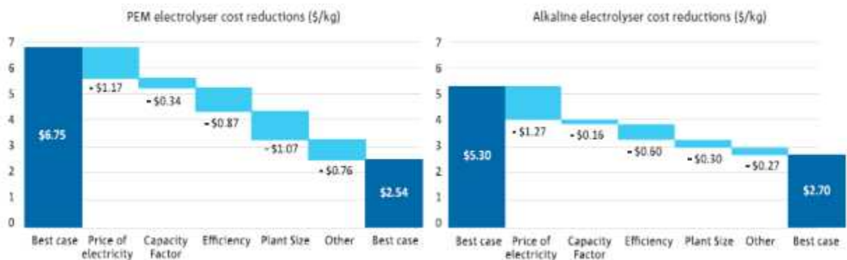
그림 8. PEM과 AE의 R&D 관점에서 기술 개발 및 최종 목표 생산단가 (호주의 National Hydrogen Roadmap 2018 참고)
