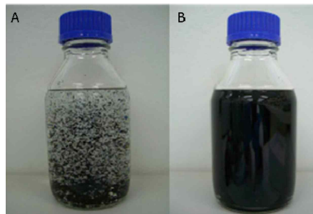
(a) 분산 전 (b) 분산 후 <그림 V-9> CNT의 분산성
