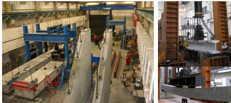
<그림 V-27> 고강도 경량 콘크리트의 부재거동 평가
