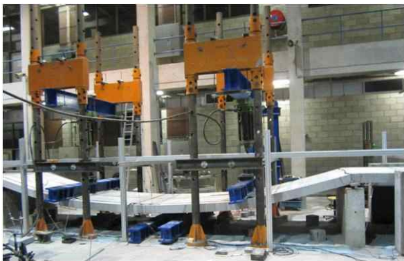
〈그림 V-102〉 고강도·고내구 경량 콘크리트 구조거동 및 Mock-Up 테스트
