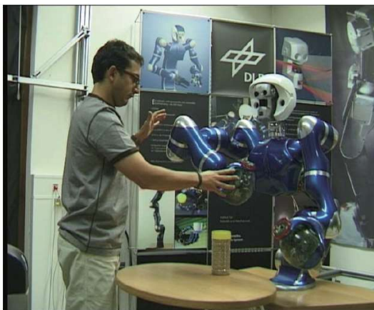
[그림 2.81] DLR의 Light weight arm
