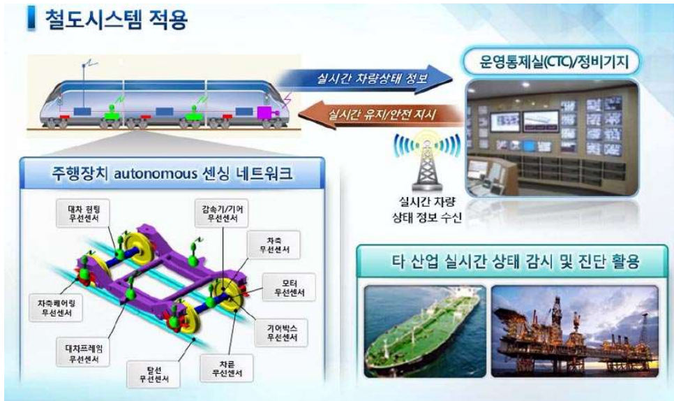
[그림 2.64] 철도시스템 미래형 무선 스마트 autonomous 센싱 기술
