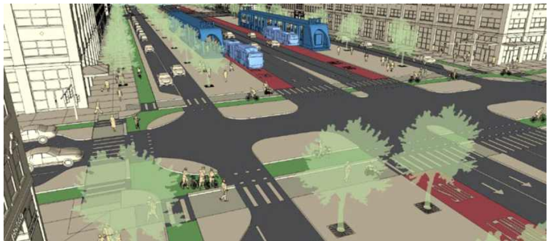
(f) 중앙도로와 평행 도로가 있는 Boulevard형 도로에 있는 서비스 도로의 내부 연석에 맞춰진 버스전용차로 예시 (Tier 2)
