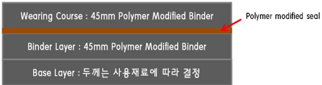
그림 2-2-34 호주 골드코스트 버스전용차로의 포장재료 및 포장단면
