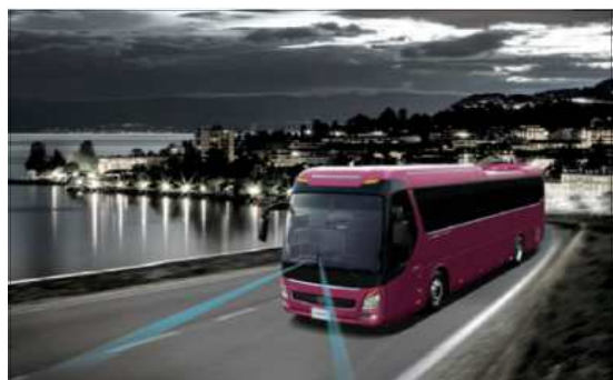
[그림 22] 신규제작차 첨단안전장치(LDWS, AEB) 작동 예시
