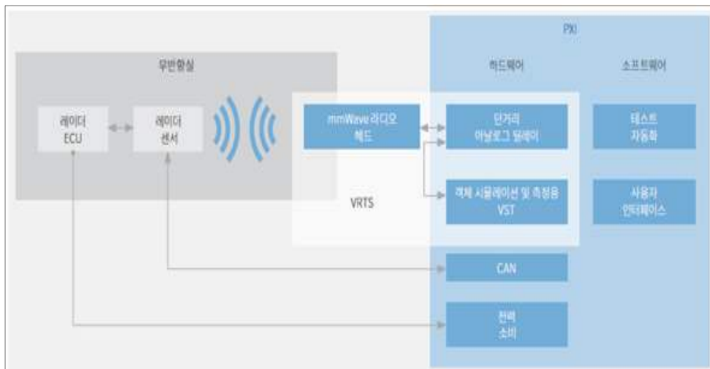
[그림 133] NI社 VRTS (Vehicle Radar Test System) 개략도
