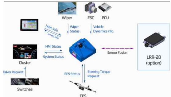
[그림 79] 차로이탈유지시스템 기능 및 관련 부품
