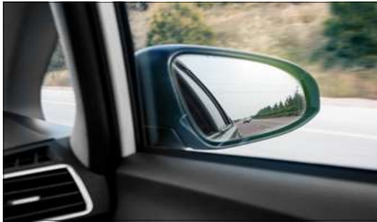
[그림 78] 사각지대경고시스템 기능 및 관련 부품
