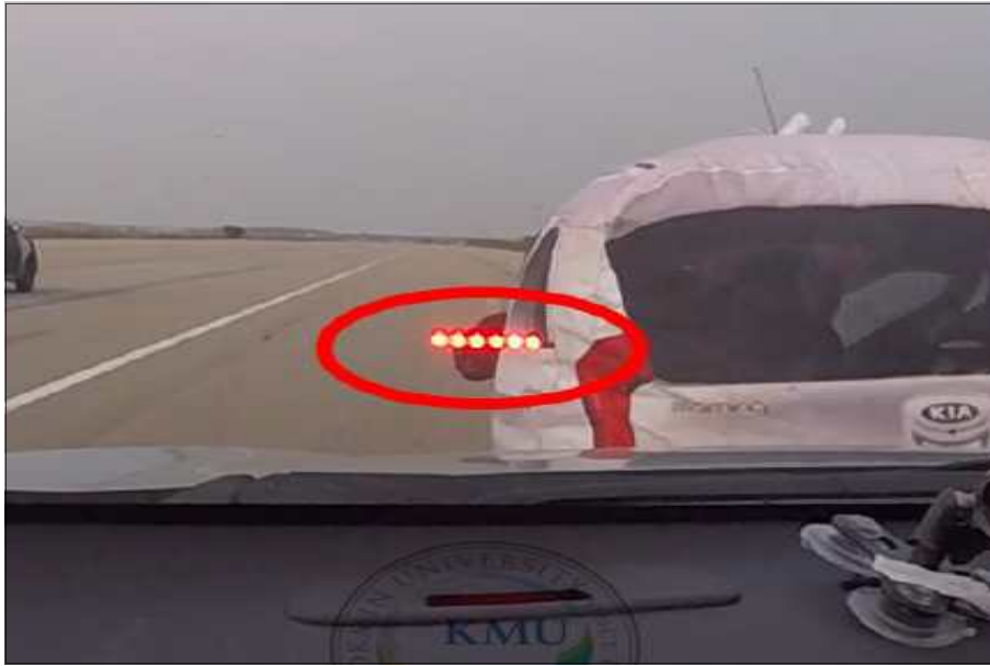
[그림 101] AEB alarm of experiment vehicle
