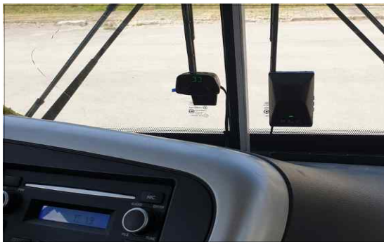
[그림 21] 운행차 첨단안전장치(LDWS, FCWS) 장착 사진
