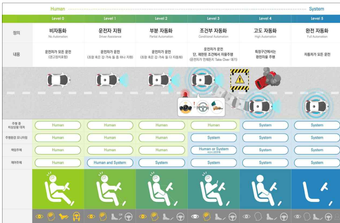
* 출처 : 자율주행자동차 제어권 전환 안전성 평가기술 개발 연구단 [그림 59] 자율주행 기술레벨 정의(SAE J3016 기반)
