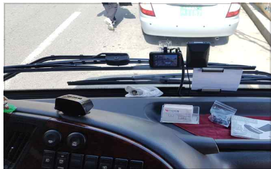
[그림 21] 운행차 첨단안전장치(LDWS, FCWS) 장착 사진
