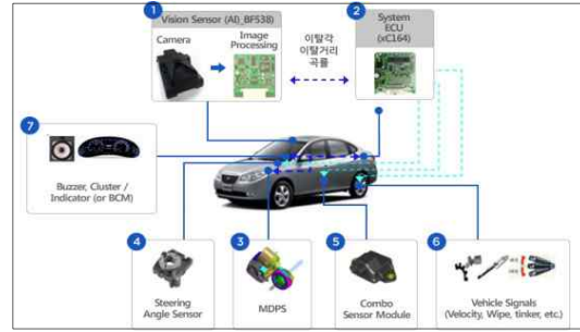
[그림 73] 차선 유지 보조시스템 관련 부품
