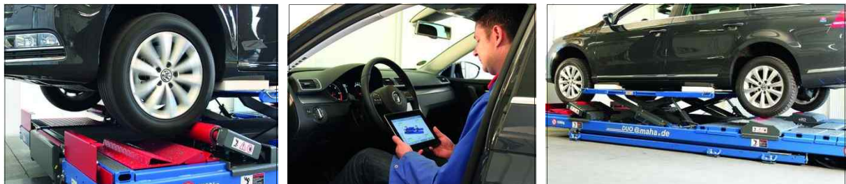
[그림 39] MAHA社 첨단안전장치 검사용 드라이빙 벤치 (model : MFP-3000)
