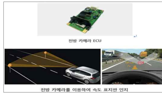
[그림 69] 속도 표지판 인식 시스템 관련 부품
