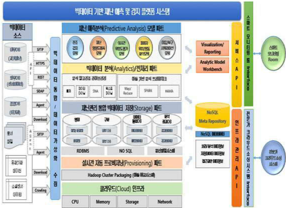
그림 28 빅데이터 기반 재난 예측 및 감지 플랫폼 시스템 구성
