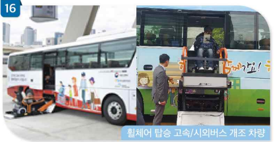
16 휠체어 탑승 고속/시외버스 개조 차량 휠체어 사용자 탑승가능한 고속/시외버스 차량
