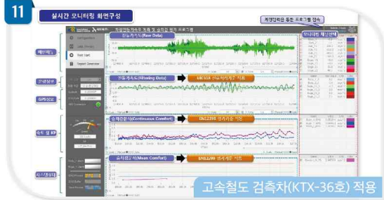
11 실시간 모니터링 화면구성 고속철도 검측차(KTX-36호) 적용 고속(300km/h) 주행 중 철도시설물 상태를 검측하는 종합검측시스템
