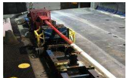
< 방향 추진시스템 머드모터 테스트 >
