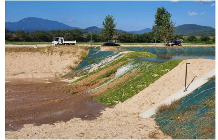
< 신소재 활용 제방 월류 시험 >
